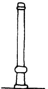
**Fahrradständer.** Vorgeschlagen wird eine Bügelkonstruktion aus zwei Pollern und einer Stange. Sie schützen einzeln aufgestellt Bänke oder stehen in größerer Stückzahl an wichtigen Anlaufstellen.
