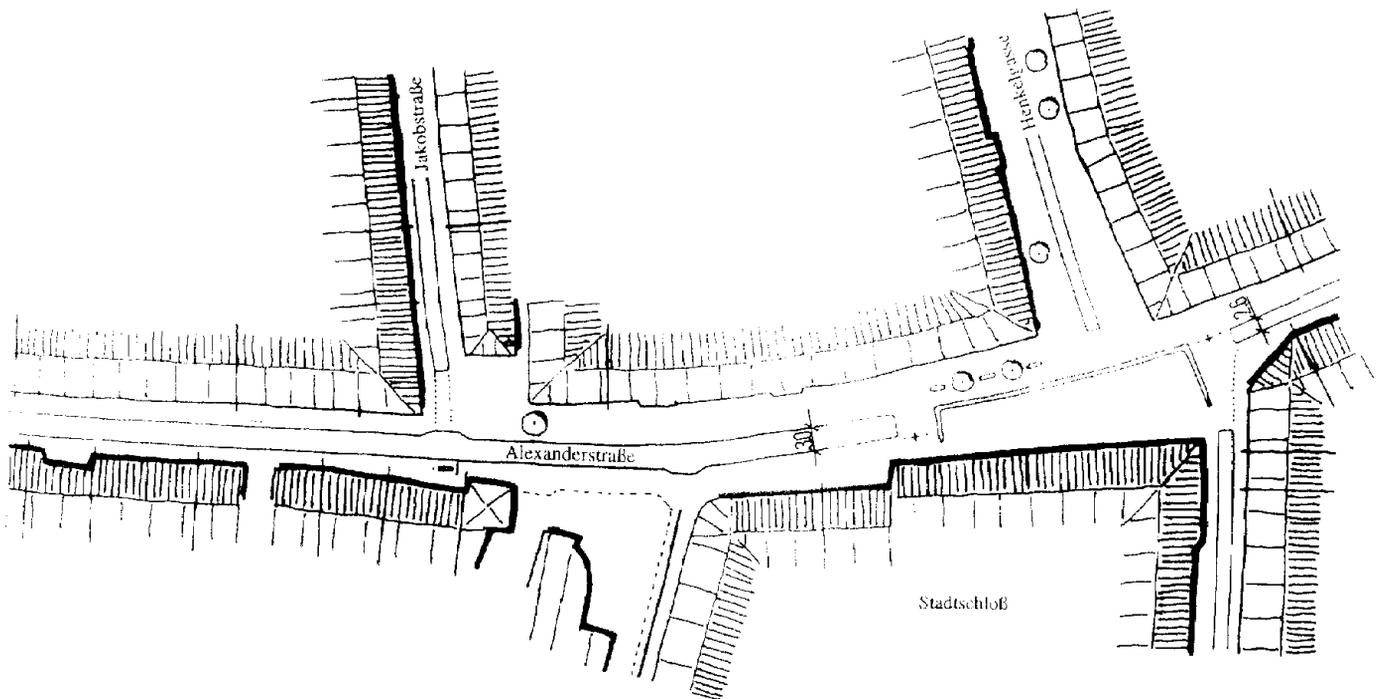
Sie erhält eine in Zeilen gepflasterte Fahrgasse aus silbriggrauem Granit (15/17 cm) mit einer Breite von 2,60 - 3,00 m. Überfahrbare, gelbliche Granitborde (4 cm hoch) trennen sie sanft von den breiten Geh- und Mehrzweckflächen aus in Bögen gepflastertem, wieder silbriggrauem Granit (10/10 cm). Sie werden zwar bei Bedarf durch LKW und PKW
